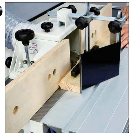
Die Fräse ist mit einem fein einstellbaren Fräsanschlag ausgestattet. Mit dem Alu-Schlitten ist Zapfenschneiden problemlos möglich.
