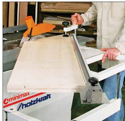
Tischausleger mit Aluminium-Ablänganschlag und verstellbarer Anschlagklappe für Platten und große Werkstücke. Stufenlos verstellbar für Gehrungsschnitte von 0 bis 45°.
