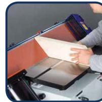
Dank stufenlos schrägstellbarem Schleifaggregat für verschiedenste Schleifvorgänge verwendbar, z. B. vertikales und horizontales Schleifen
