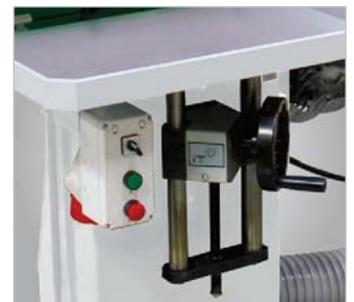
Höhenverstellbarer Schleiftisch zur Ausnutzung der gesamten Schleifbandbreite
