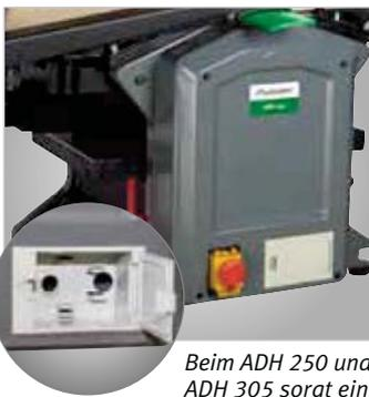
Beim ADH 250 und ADH 305 sorgt ein integriertes Aufbewahrungsfach für Stauraum. So kann z.B. kleines Bedienwerkzeug platzsparend aufbewahrt und mitgeführt werden.
