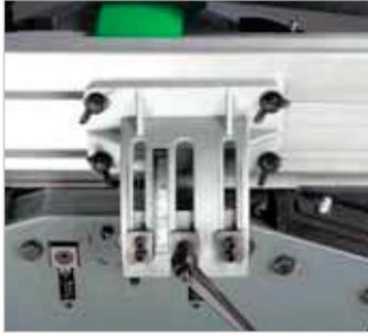
Der Aluminium-Abrichtanschlag ist um 45° stufenlos neigbar. Die eingestellte Neigung ist bequem an einer Skala ablesbar. (Abb. zeigt ADH 250)
