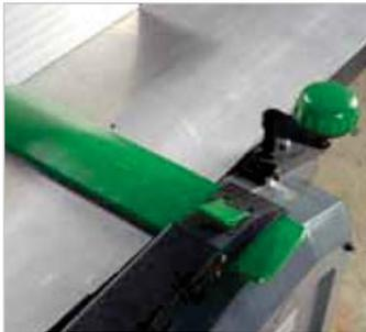
Die Hobelmesser sind durch einen Schutz mit praktischem Schnellspanner abgedeckt. An einer Handkurbel kann die gewünschte Späneabnahme für das Dickenhobeln bis zu 2 mm einfach eingestellt werden. Sie ist an einer Skala bequem ablesbar (Abb. zeigt ADH 250).
