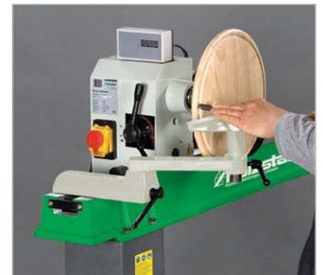
Für Drechselarbeiten an Werkstücken im Querholzbetrieb, die größer als das Stichmaß der Bank sind, kann der Spindelstock geschwenkt werden. Die Bettverlängerung in Verbindung mit der umsteckbaren Handstahlaufgabe ermöglichen maximale Flexibilität.
