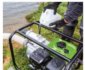
**Einfache Erzeugung des Unterdrucks in der Pumpe**
