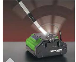
Durch die umlegbare Deichsel lässt sich die Maschine mühelos in alle Richtungen manövrieren und macht randnahes Arbeiten möglich
