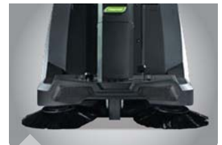
Arbeitsbreite ohne Seitenbesen 580 mm
